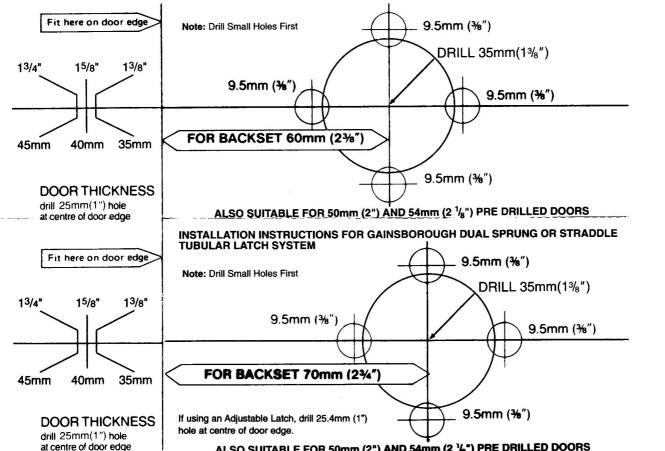
INSTALLATION INSTRUCTIONS FOR GAINSBOROUGH DUAL SPRUNG OR STRADDLE TUBULAR LATCH SYSTEM
